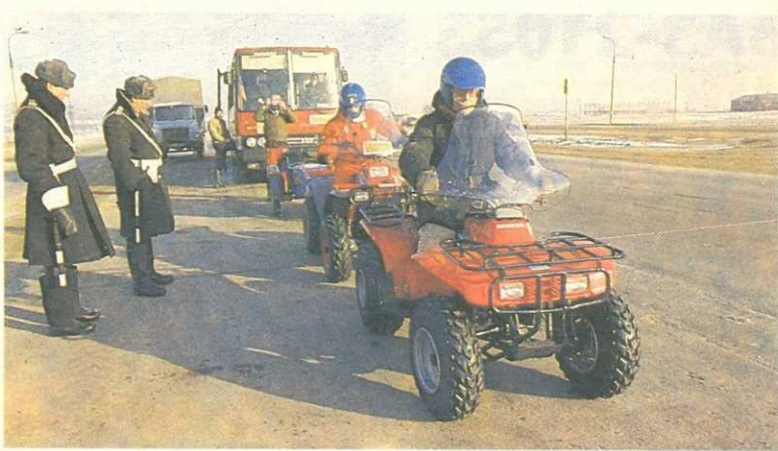
Старт пробега. На переднем плане вездеход «Хонда-Фур Трекс-300» [двигатель — четырехтактный, 282 см 3 , 28 л. с., с воздушным охлаждением; привод — на задние колеса].
