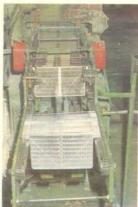
Решетки двух пластин, определяющие долговечность батарей (в процессе эксплуатации они разрушаются), отламывают из свинцового сплава на автоматической линии.
