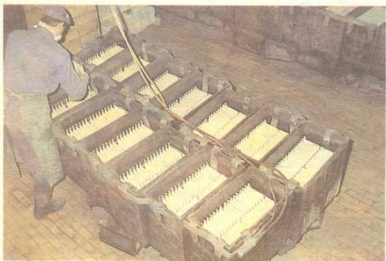
Пластины помещают в баки, заливают электролитом и заряжают, чтобы готовая батарея была «сухозаряженной». Ее приводят в рабочее состояние, лишь заполнив электролитом.
